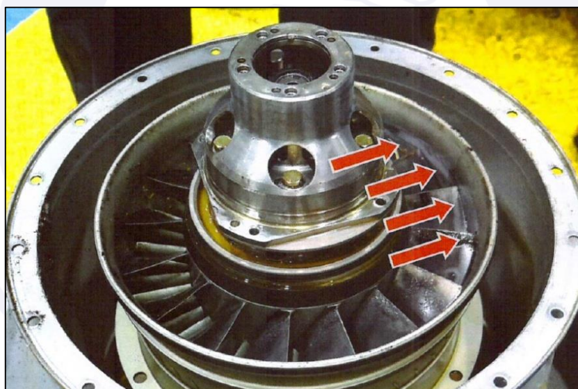
Figura 27 - Vista do rotor do primeiro estágio do compressor do motor esquerdo com marcas de roçamento observadas na carcaça.
