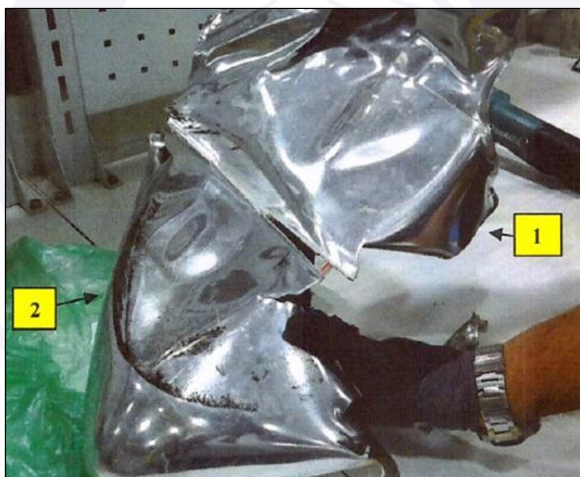
Figura 33 - Marcas de impacto no spinner do motor esquerdo.
