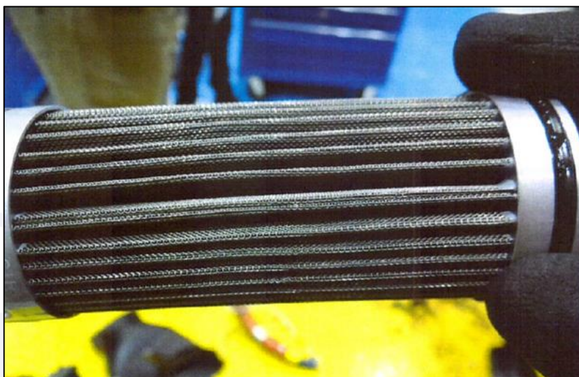
Figura 32 - Filtro de óleo do motor esquerdo sem anormalidades.
