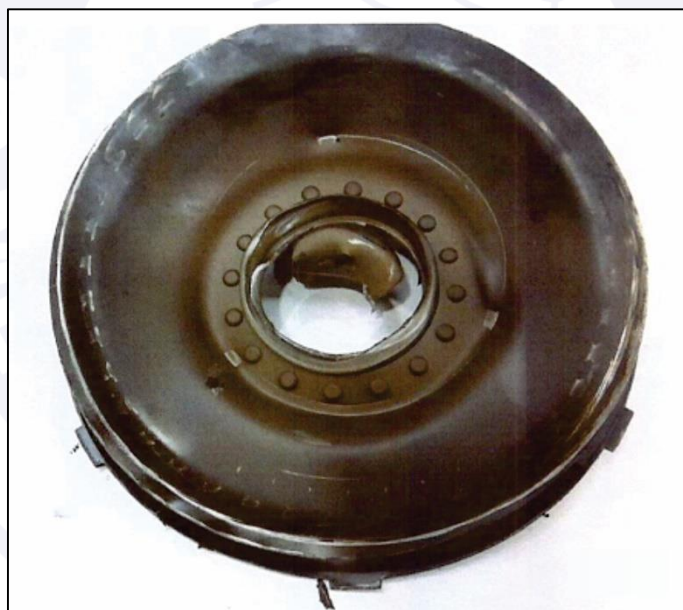
Figura 29 - Vista posterior do diafragma do motor esquerdo com marcas suaves de roçamento e de impacto com o rotor da turbina de potência parado.
