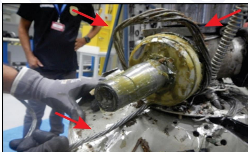
Figura 37 - Cabo para-raios enrolado no eixo da hélice do motor esquerdo (indicado pelas setas vermelhas).
