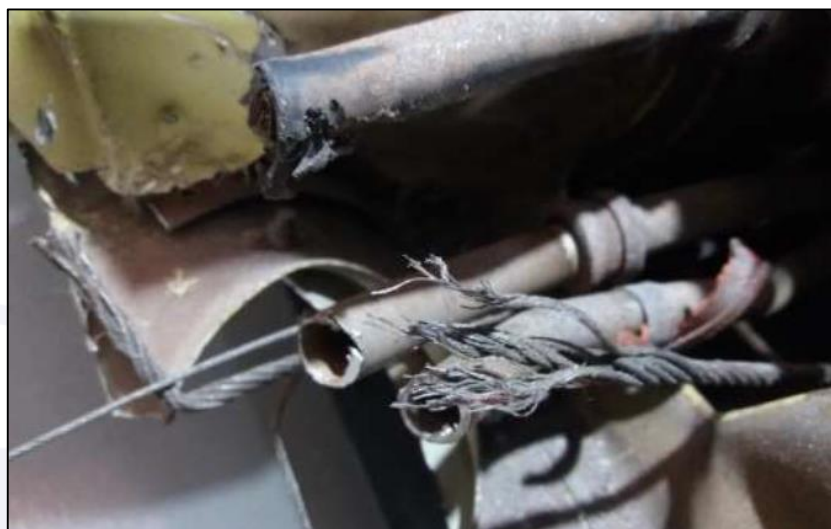
Figura 23 - Cabos de comando da aeronave com indicativo de sobrecarga.
