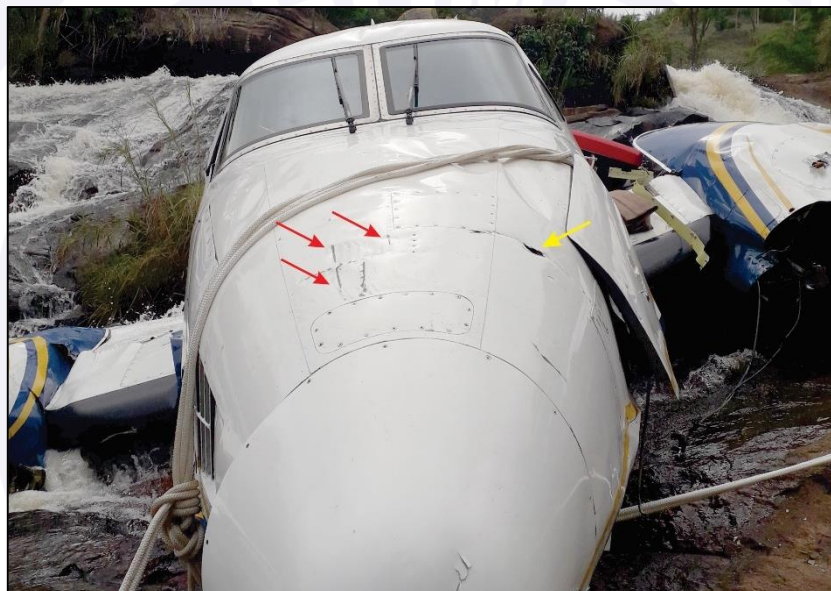
Figura 40 - Marcas de contato do cabo contra o nariz da aeronave. As setas vermelhas apontam marcas de atrito e a seta amarela mostra um dos pontos de perfuração do revestimento.
