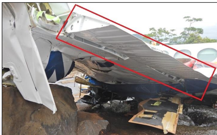
Figura 20 - Posição dos flapes da asa esquerda após o impacto contra o solo.
