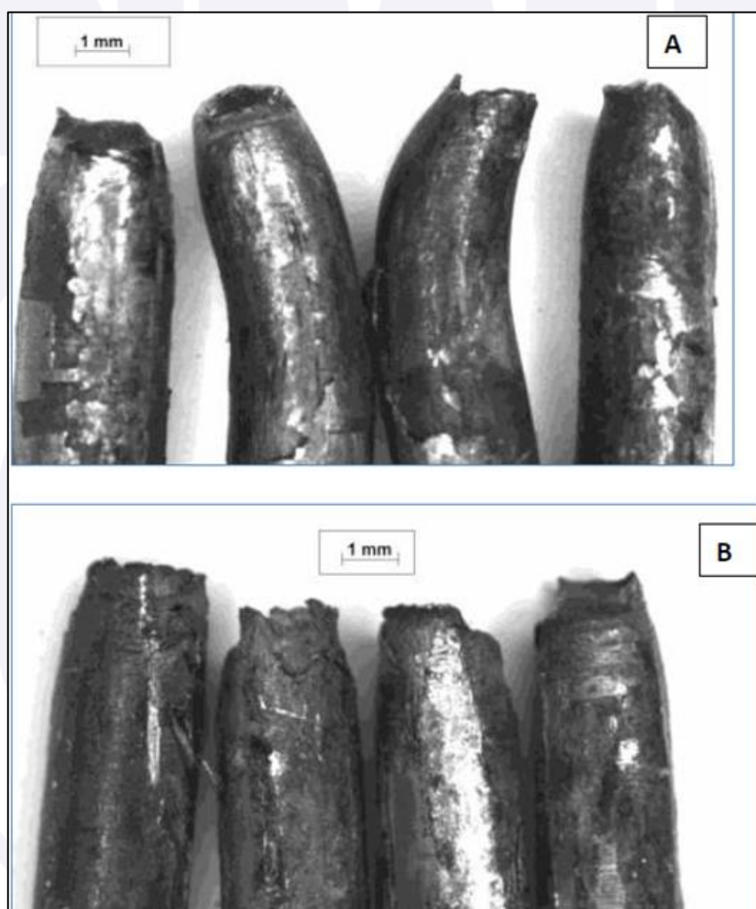
Figura 38 - Fotoestereoscopias do cabo removido do eixo do motor (A) e cabo submetido ao ensaio de tração (B).
